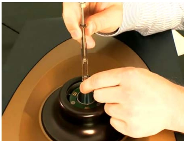
セルへの溶液注入
