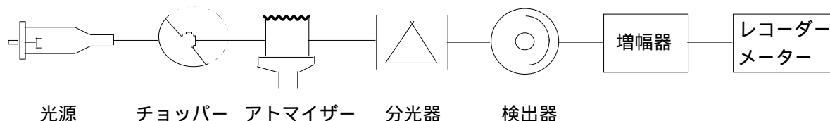
Fig. 1 原子吸光光度計の構成
